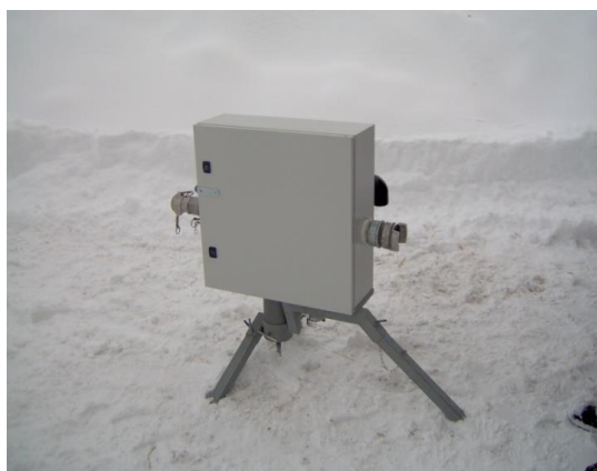
Limiteur de pression développé par Serre Chevallier-Vallée en collaboration avec le SDIS 05
